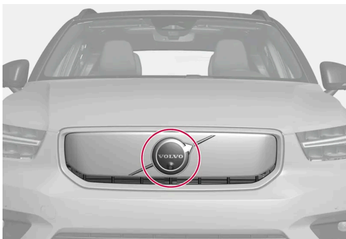
Umiejscowienie przedniego modułu radarowego
