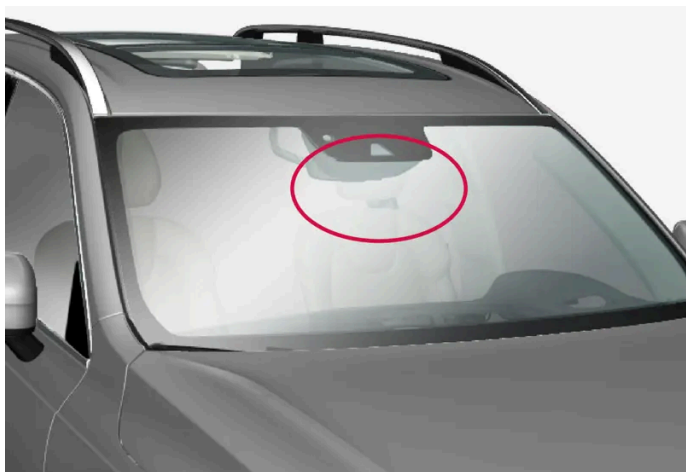
Umieszczenie przedniego modułu kamery
