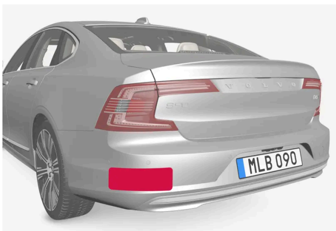
Umiejscowienie tylnych modułów radarowych
