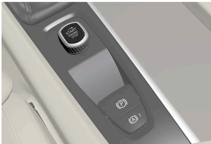
Pokrętko rozruchu na konsoli między fotelami.
