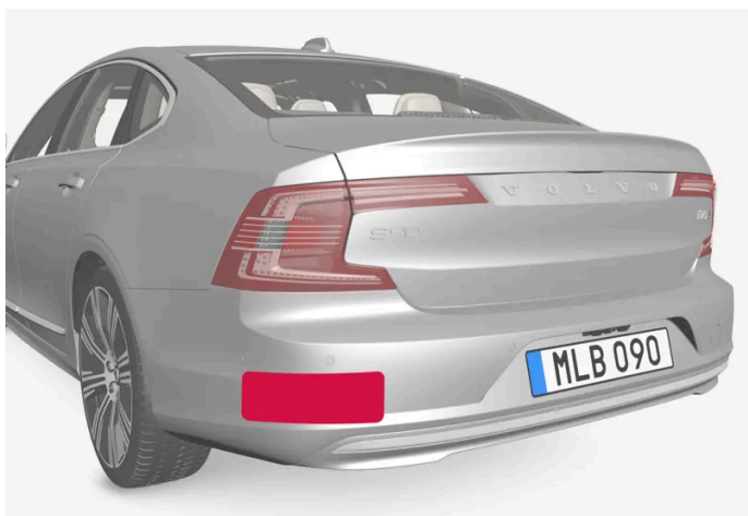
Umiejscowienie tylnych modułów radarowych
