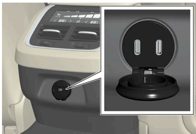
Gniazda USB (typu C) w konsoli między fotelami, siedzenie tylne.
