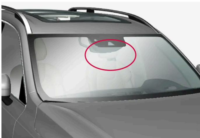
Umiejscowienie modułu kamery
