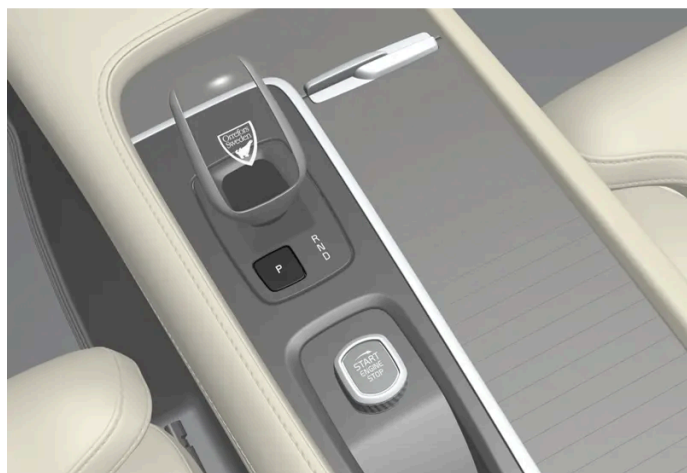
Prezentacja dźwigni zmiany biegów i położenia P.
