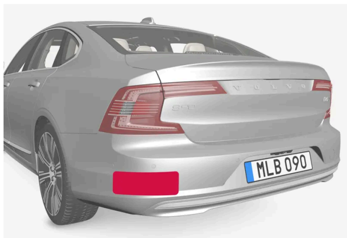
Umiejscowienie tylnych modułów radarowych
