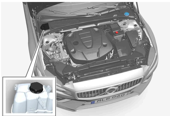
Zbiornik wyrównawczy płynu chłodzącego
