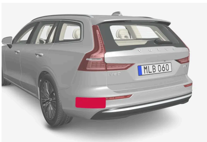
Umiejscowienie tylnych modułów radarowych
