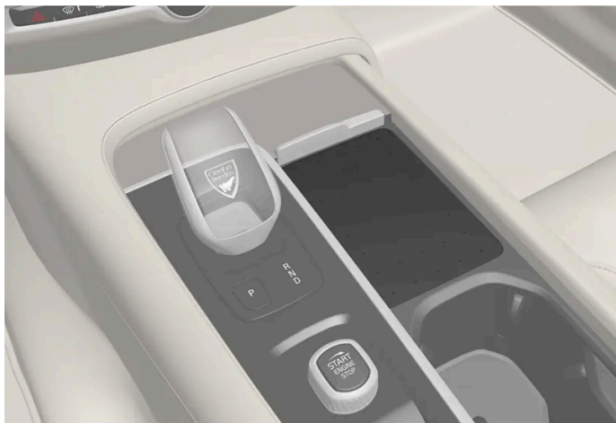
Bezprzewodowa ładowarka do telefonu w konsoli między fotelami.
