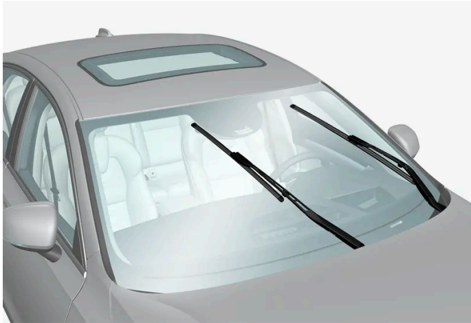
Pióra wycieraczek w pozycji serwisowej.
