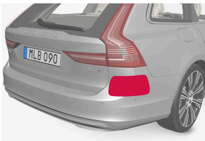
Umiejscowienie tylnych modułów radarowych
