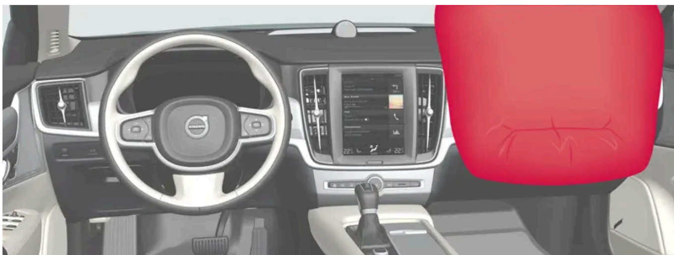
Czołowa poduszka powietrzna pasażera przedniego fotela.
