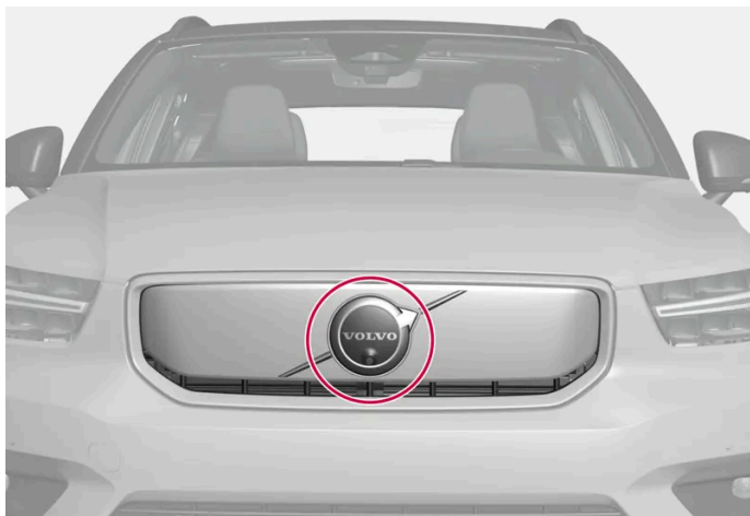
Umiejscowienie przedniego modułu radarowego
