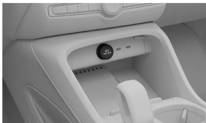
Gniazdo elektryczne 12 V na konsoli między fotelami
