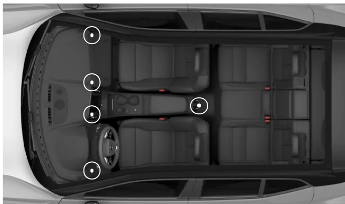
Rozmieszczenie regulowanych nawiewów
