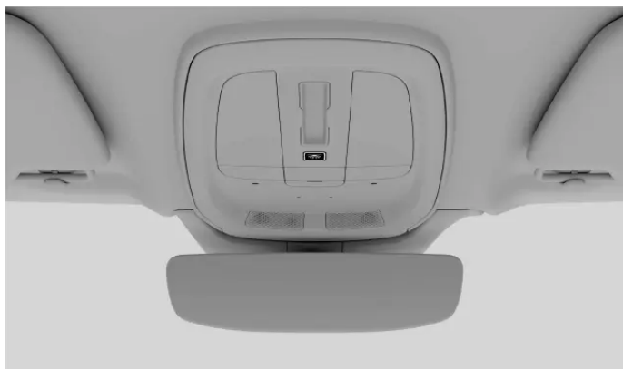
Przycisk automatycznego wyłączania oświetlenia na konsoli sufitowej
