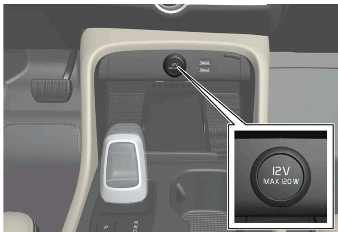
Gniazdo elektryczne 12 V w konsoli między fotelami, fotele przednie.
