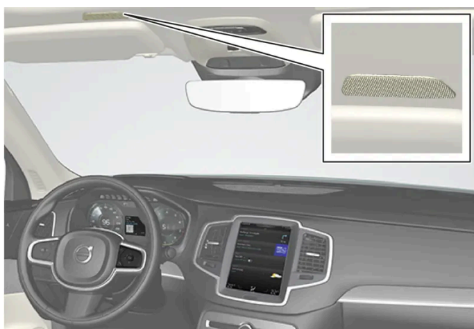
Mikrofon systemu sterowania poleceniami głosowymi
