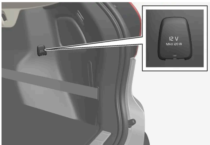
Gniazdo elektryczne 12 V w przestrzeni bagażowej*.
