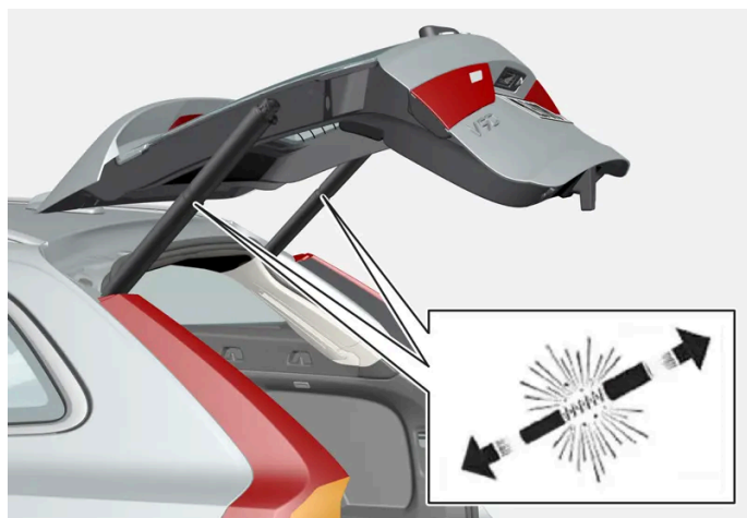
Sprężyny gazowe do sterowanych elektrycznie drzwi bagażnika.
