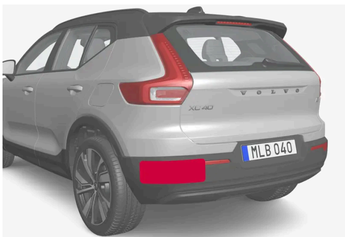
Umieszczenie tylnych modułów radarowych
