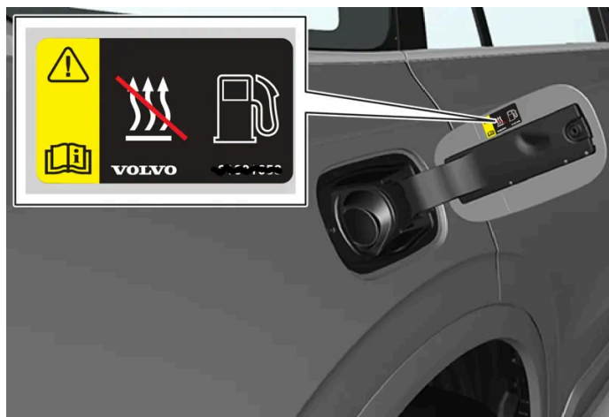
Etykieta ostrzegawcza na pokrywie wlewu paliwa.
