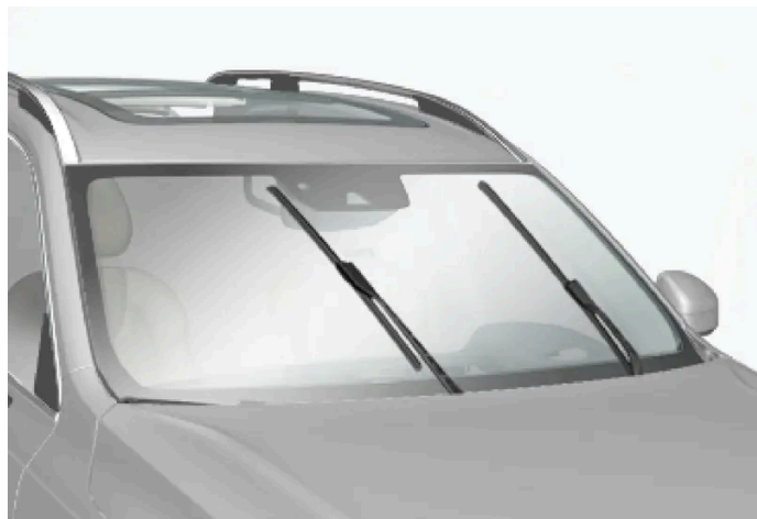
Pióra wycieraczek w pozycji serwisowej.
