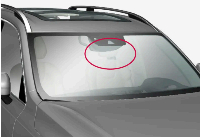
Umiejscowienie przedniego modułu radarowego
