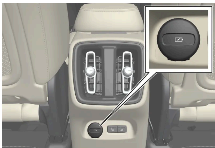
Gniazda USB* (typu C) z tyłu konsoli między fotelami, służące do ładowania na przykład telefonów i tabletek [1] .
