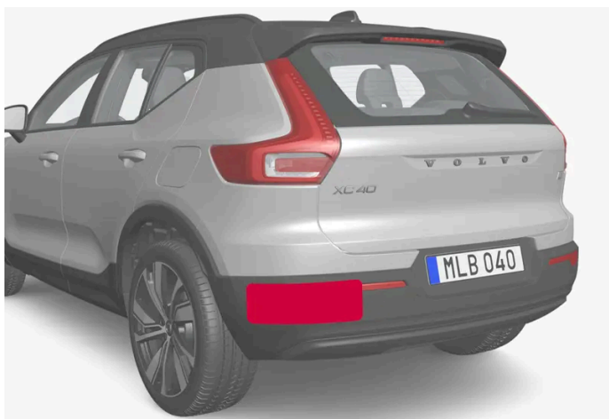
Umiejscowienie tylnych modułów radarowych
