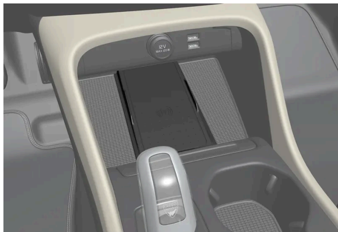
Bezprzewodowa ładowarka telefonu przed dźwignią zmiany biegów
