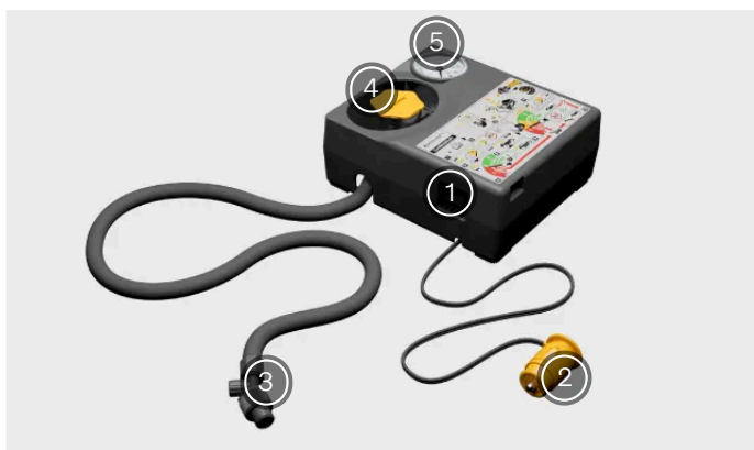
Przegląd sprężarki awaryjnego zestawu naprawczego do ogumienia
