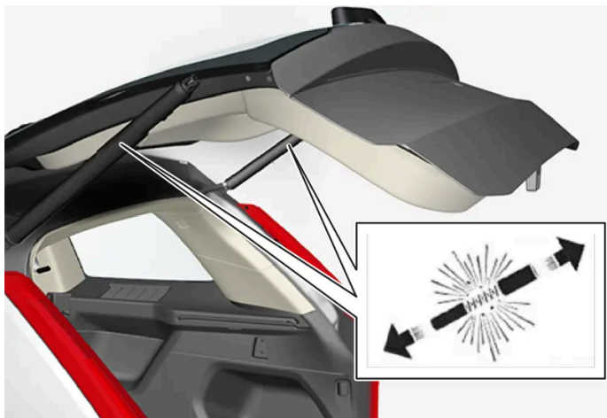
Sprężyny gazowe do sterowanych elektrycznie drzwi bagażnika.
