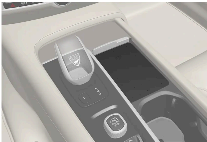
Bezprzewodowa ładowarka do telefonu w konsoli między fotelami.
