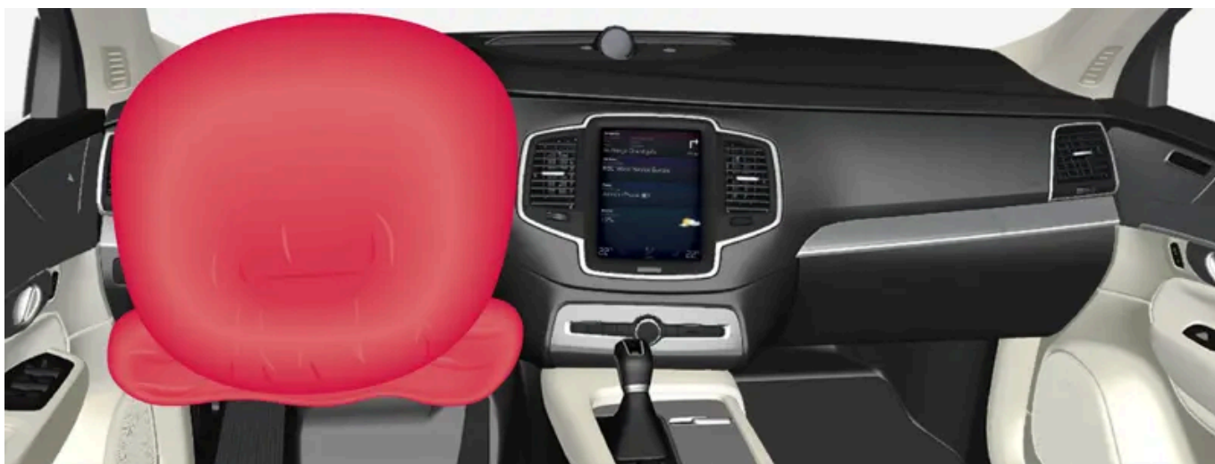
Poduszka powietrzna w kierownicy i kolanowa poduszka powietrzna przy przednim fotelu po stronie kierowcy.
