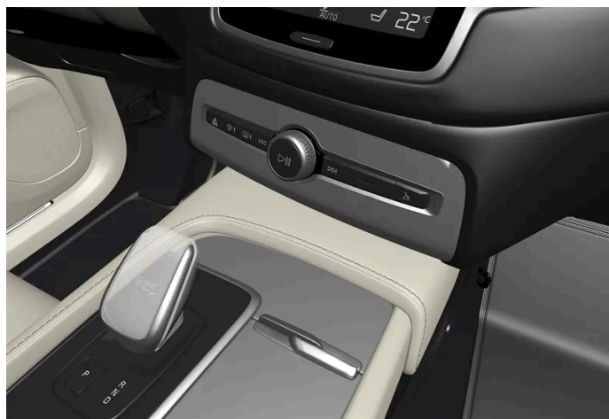
Prezentacja małej dźwigni zmiany biegów, w przypadku której nie ma możliwości wyłączenia blokady dźwigni skrzyni biegów.
