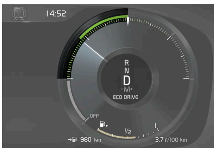
Wskaźnik ECO na 12-calowym wyświetlaczu kierowcy*.
