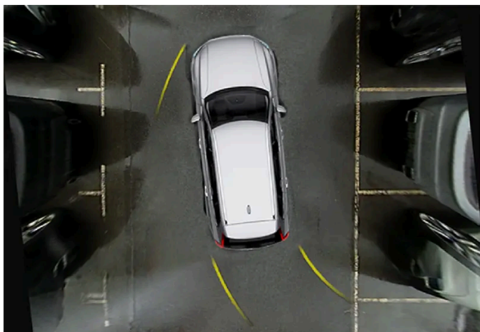
Widok 360° z liniami pomocniczymi układu wspomagania parkowania
