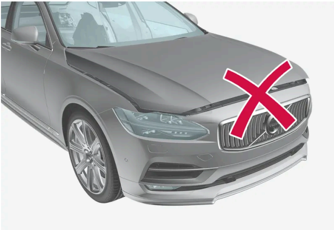
Niedomknięta pokrywa silnika.
