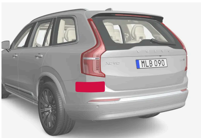
Umieszczenie tylnych modułów radarowych
