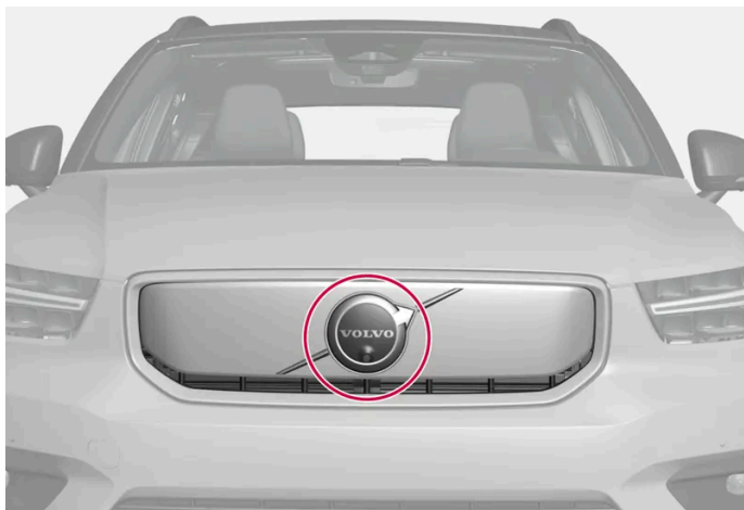
Umieszczenie przedniego modułu radarowego
