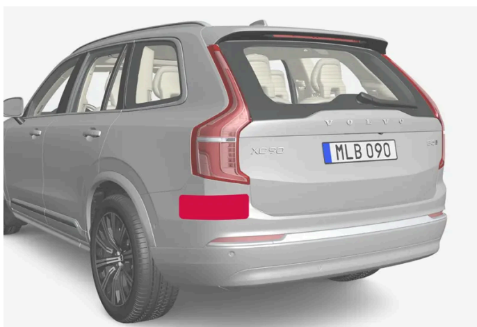
Umiejscowienie tylnych modułów radarowych
