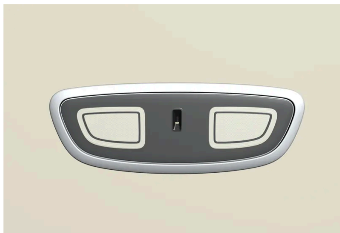
Lampki do czytania nad tylnymi siedzeniami. [1]
