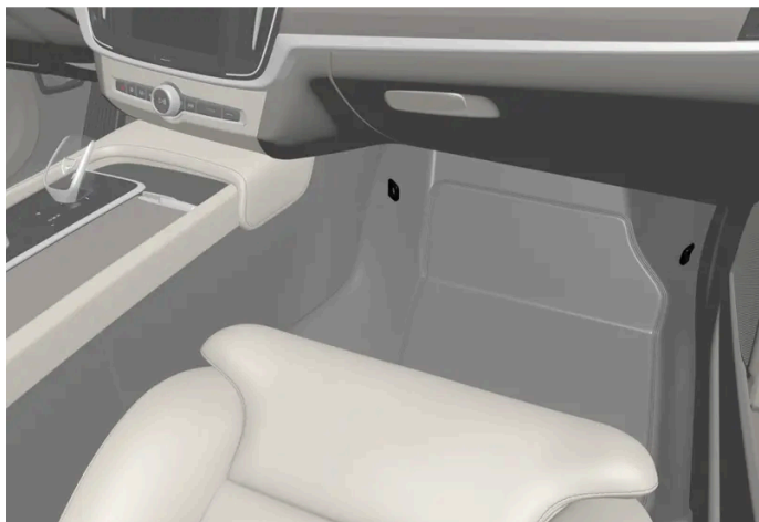
Rozmieszczenie zaczepów mocujących w fotelu przednim.
