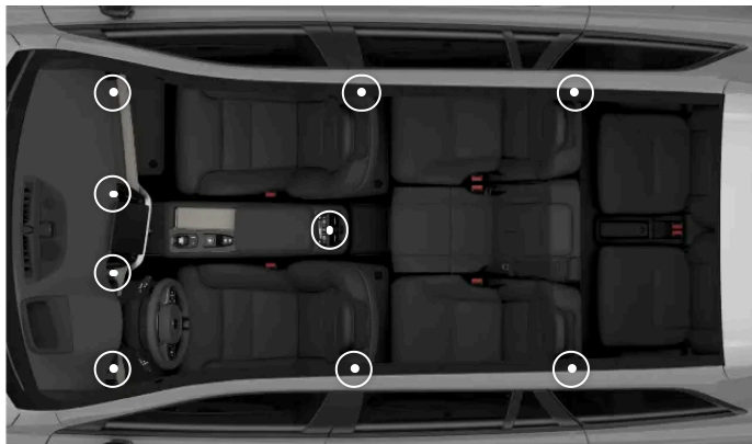
Rozmieszczenie regulowanych nawiewów
