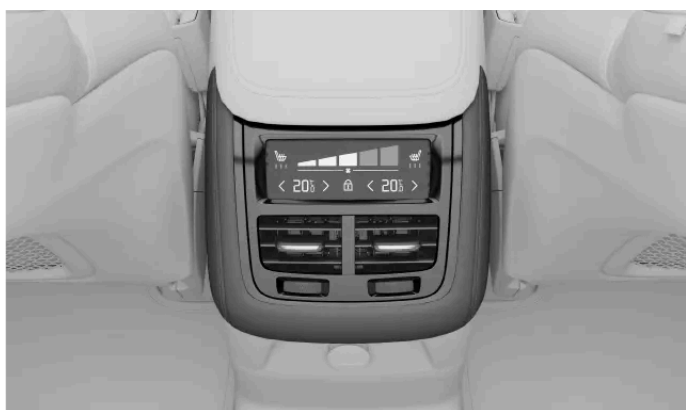
Elementy sterujące klimatyzacją na konsoli między fotelami
