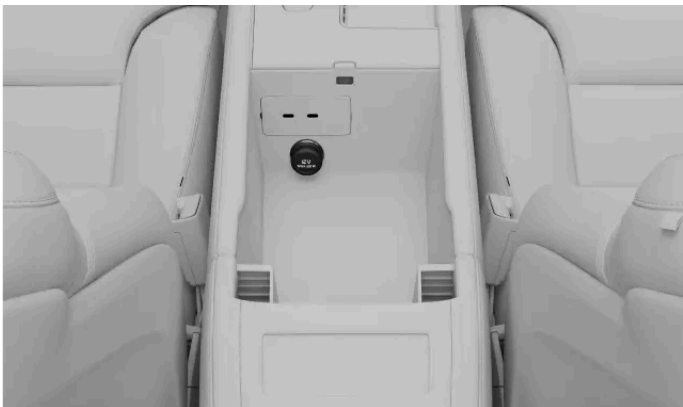
Gniazdo elektryczne 12 V na konsoli między fotelami
