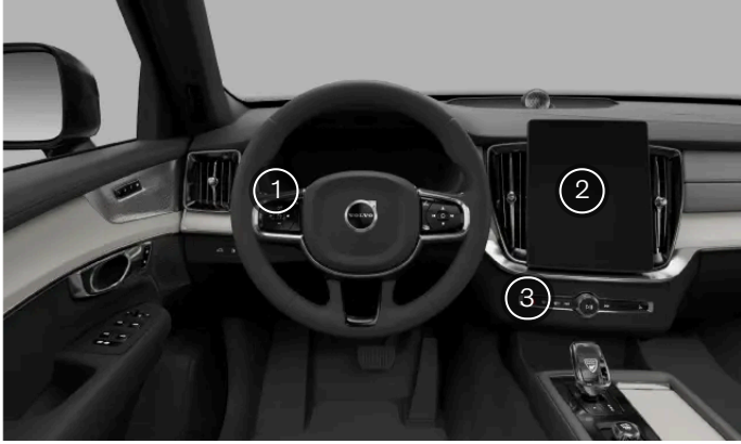
Rozmieszczenie elementów sterujących światłami zewnętrznymi
