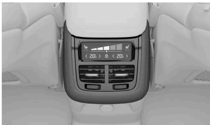
Elementy sterujące klimatyzacją na konsoli między fotelami
